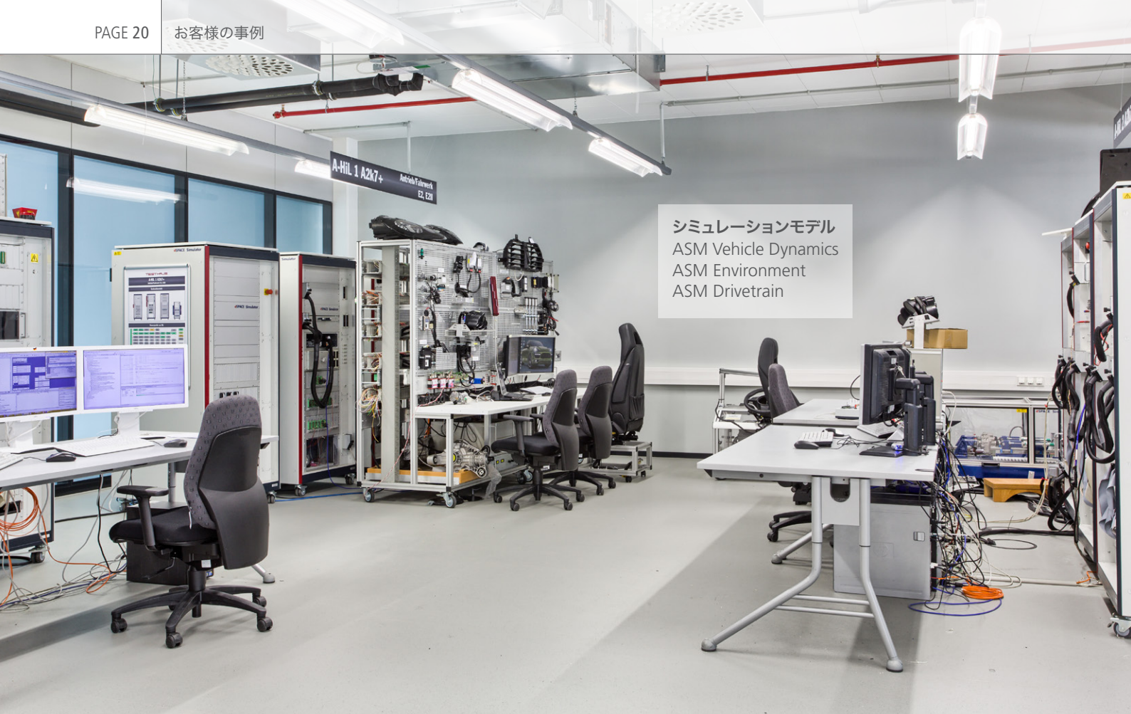
図1：駆動系およびシャシーアプリケーションの妥当性確認を行うHILテストベンチ。ECUの取り付けや実部品（スロットルバルブ、インジェクタ、トランスミッションバルブ、電子制御パーキングブレーキ用アクチュエータ、ラジエータシャッタなど）の統合を行うためのセットアップは、写真中央後方にあります。
