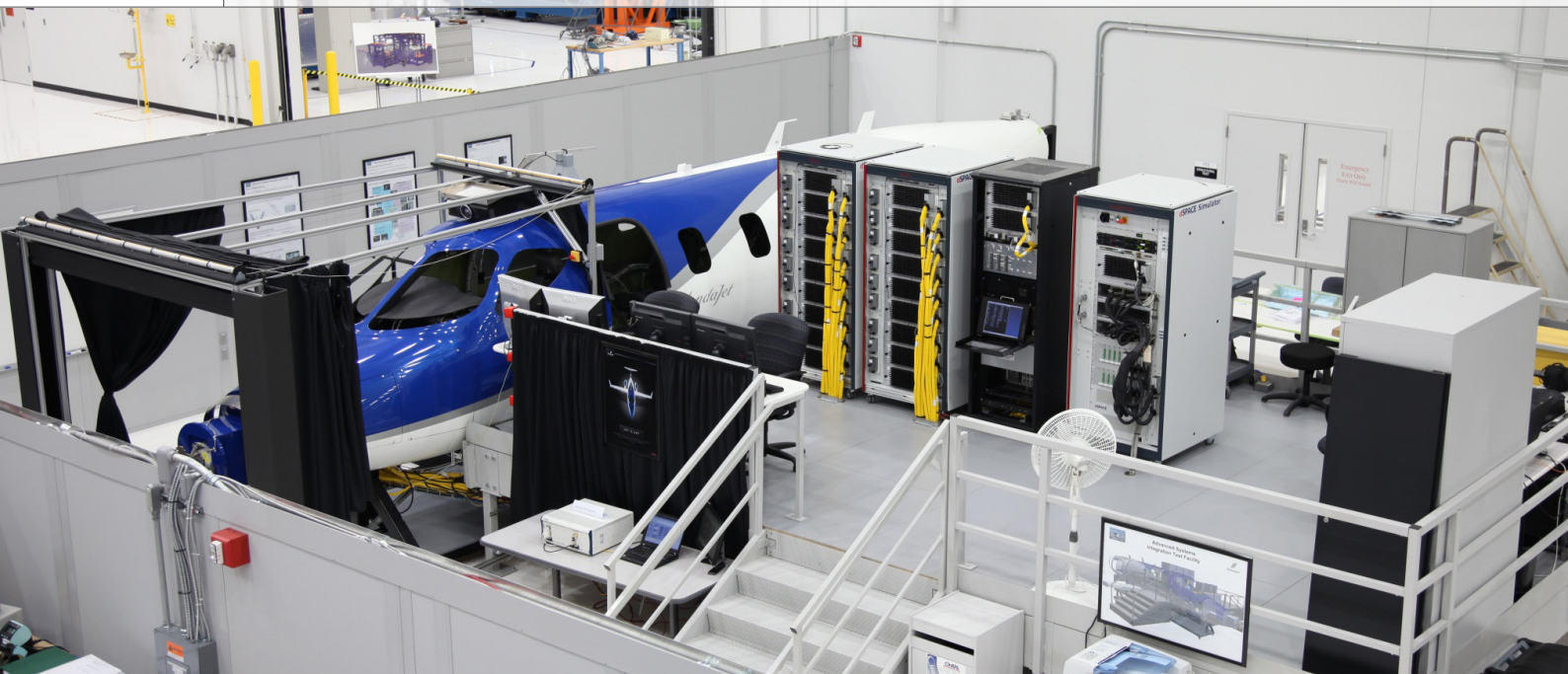
アイアンバード (左) と 3 台の dSPACE HIL シミュレータを含むテストラボ (中央)
