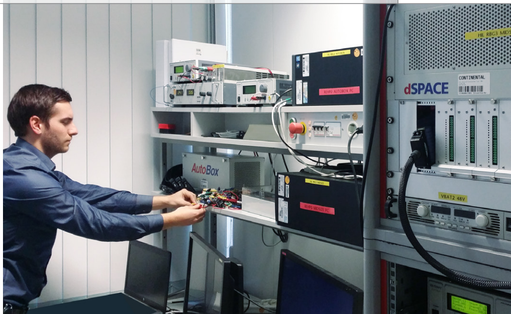
図 2 : Continental 社 (レーゲンスブルク) での HIL テスト装置の 1 つ
