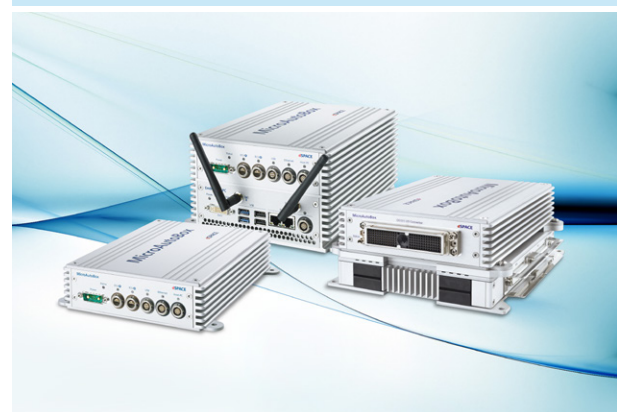
MicroAutoBox II は、汎用的なリアルタイム対応の開発システムです。Embedded PC (中央) およびシグナルコンディショニングを提供する RapidPro SC Unit (右側) による拡張も可能です。
