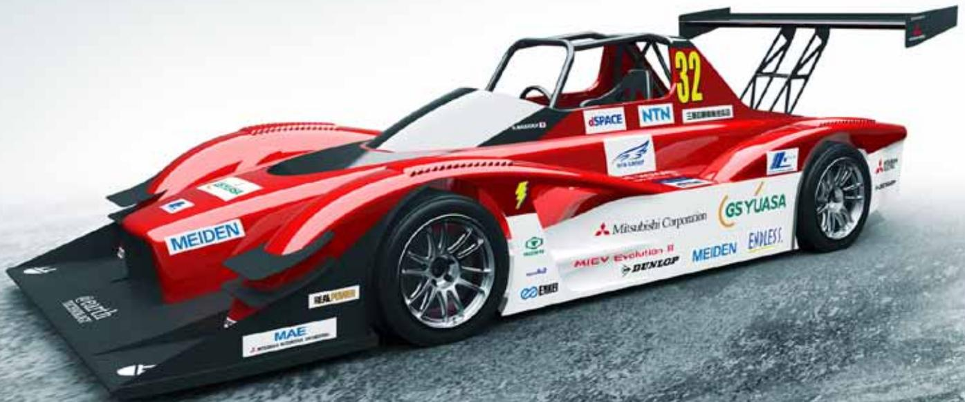
MiEV Evolution III 赛车：最大总输出功率为 450 千瓦（612 马力）的 4 个电动机。
