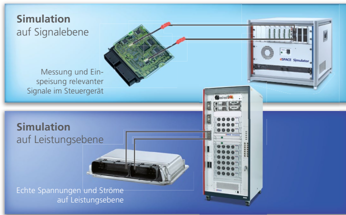
Test von Steuergeräten mit Leistungsendstufen: Zur Simulation auf Leistungsebene werden die realen Ströme und Spannungen der Regelstrecke an der Leistungsendstufe des Steuergerätes emuliert (unten). Die Simulation auf Signalebene erfolgt am geöffneten Steuergerät mit Signalen, die vor der Leistungsstufe abgegriffen beziehungsweise eingespeist werden (oben).
