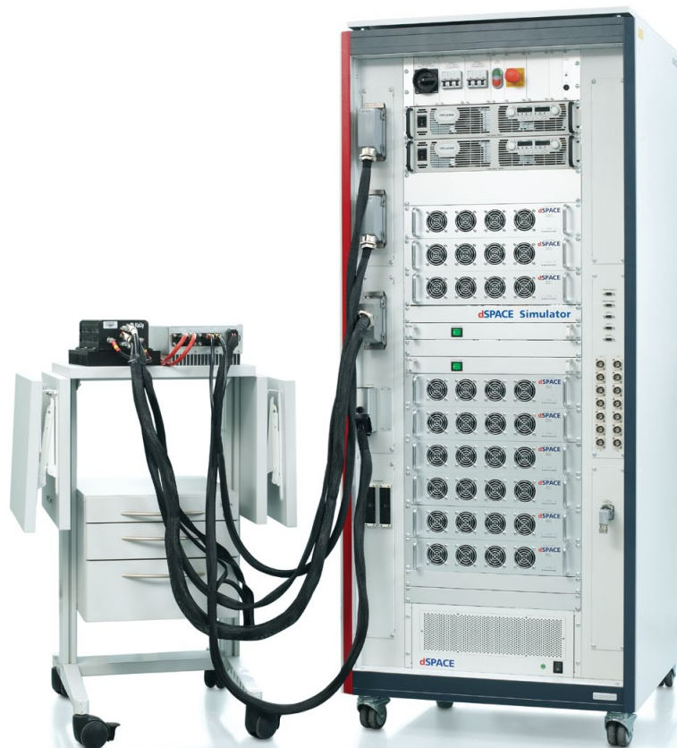
Das Testsystem, bestehend aus einem dSPACE Simulator und den angeschlossenen Steuergeräten.
