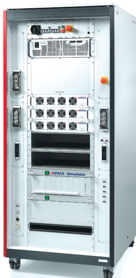
dSPACE Simulator mit hochdynamischem Lastemulator DS5381 (Mitte).
