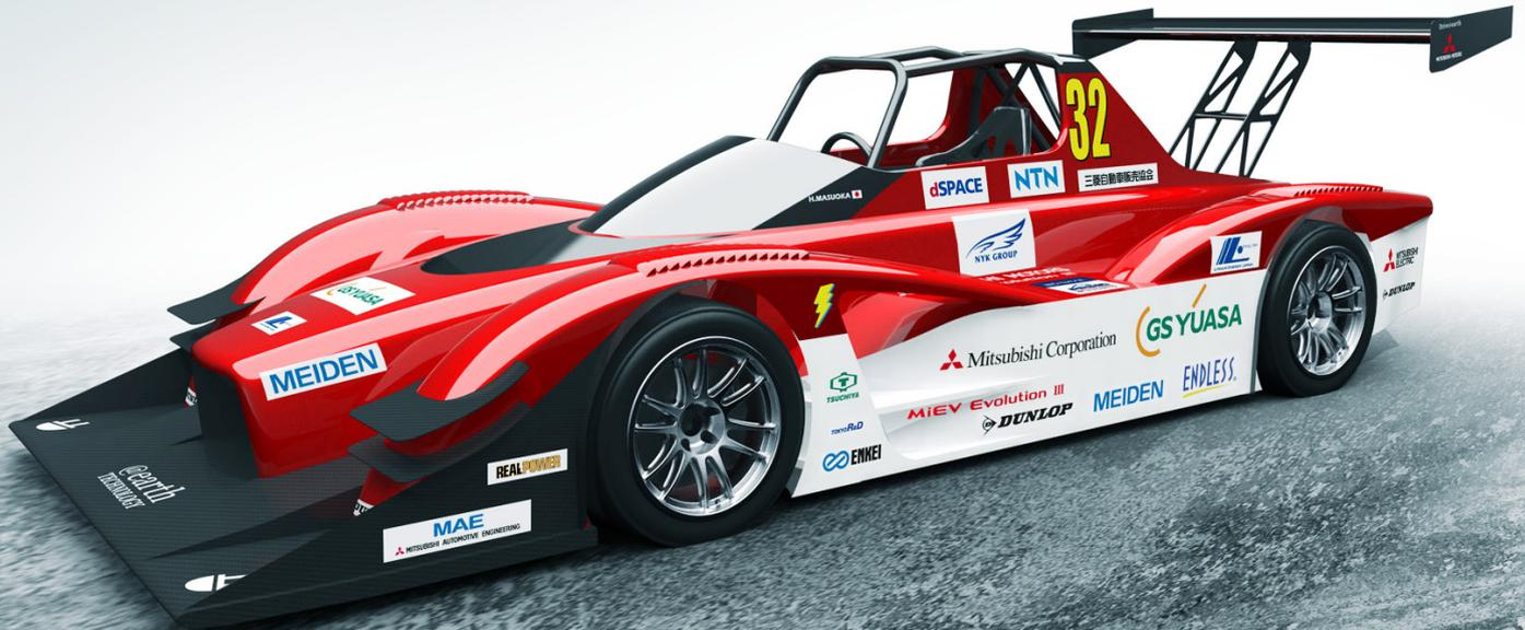
MiEV Evolution III : 4基のモーターで合計 450 kW (612 hp) を出力
