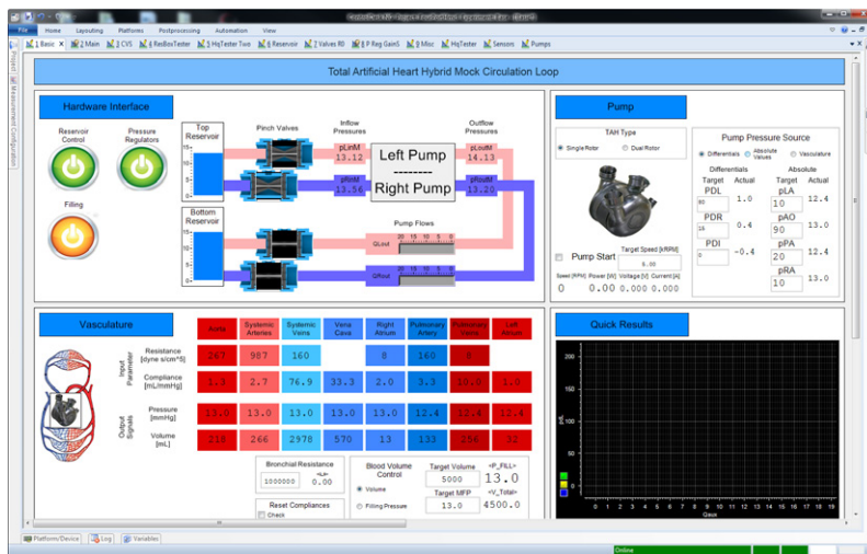
図3: dSPACE 試験ソフトウェアControlDesk Next Generationは中央ユーザインターフェースとして機能し、データの記録、パラメータの変更、および各種システム状態のグラフィカルな表示を行います。
