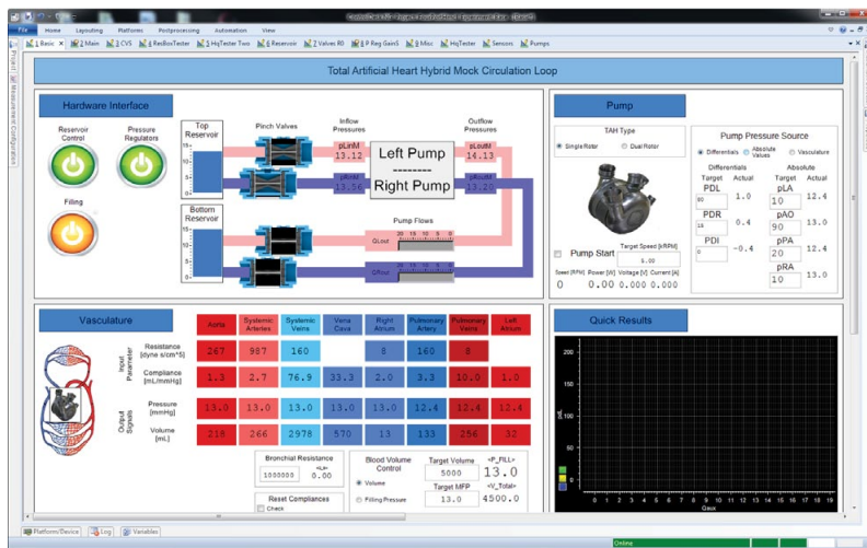
Abbildung 3: Die dSPACE Experimentiersoftware ControlDesk Next Generation dient als zentrale Bedienoberfläche u.a. zur Datenaufnahme, Parameteränderung und zur grafischen Darstellung verschiedenster Systemzustände.
