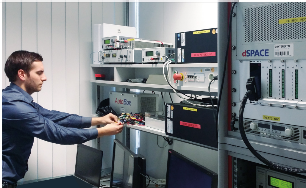
Abbildung 2: Einer der HIL-Teststände bei Continental in Regensburg.
