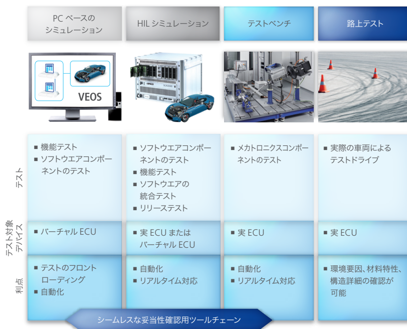
図 1: dSPACE ツールチェーンは、複数のテストフェーズにわたってシームレスに使用されています。
