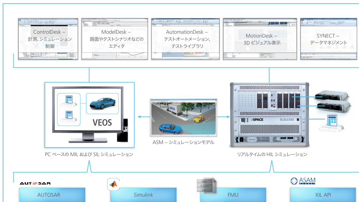
図 3: シームレスなツールチェーンとさまざまな規格のサポートにより、テストシナリオ、モデル、および設定の相互交換を早期の段階で行うことができます。
