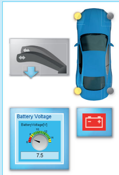
図1 (左) : 信号ベースのテストの動作概要を示しています。この例では、低い車両電圧 (7.5 V) でウィンカースイッチをオンにした場合のウィンカーの動作をテストしています。
