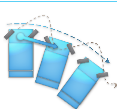
図 1 : 右方への車両移動の例 : ジョイスティックを右に倒して保持すると、車両は「間接移動」モードで自動的に移動
