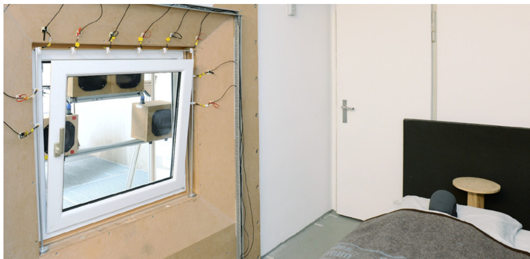
図1：騒音が窓に届く前に、ノイズキャンセルスピーカが騒音を低減（第3のプロジェクト段階）。
