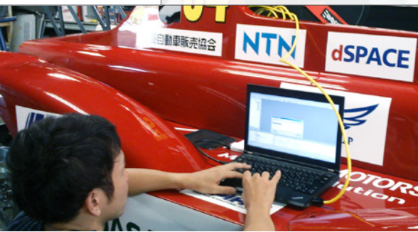
図1～4：上から下へ：MicroAutoBox II に実装したコントローラの最終調整、パイクスピークに出場したレーシングチーム、それぞれ3位と2位の賞を手にしたドライバーの Greg Tracy 氏 (左側) と増岡浩氏 (右側)、参戦車両 MiEV Evolution II
