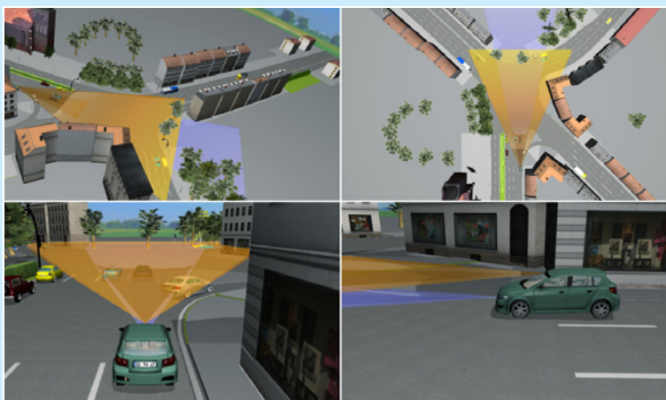
図4：MotionDeskでの、さまざまな視点からの交差点の表示。モノラルカメラとレーダーセンサの視界が、オレンジとブルーに色分けして表示されています。
