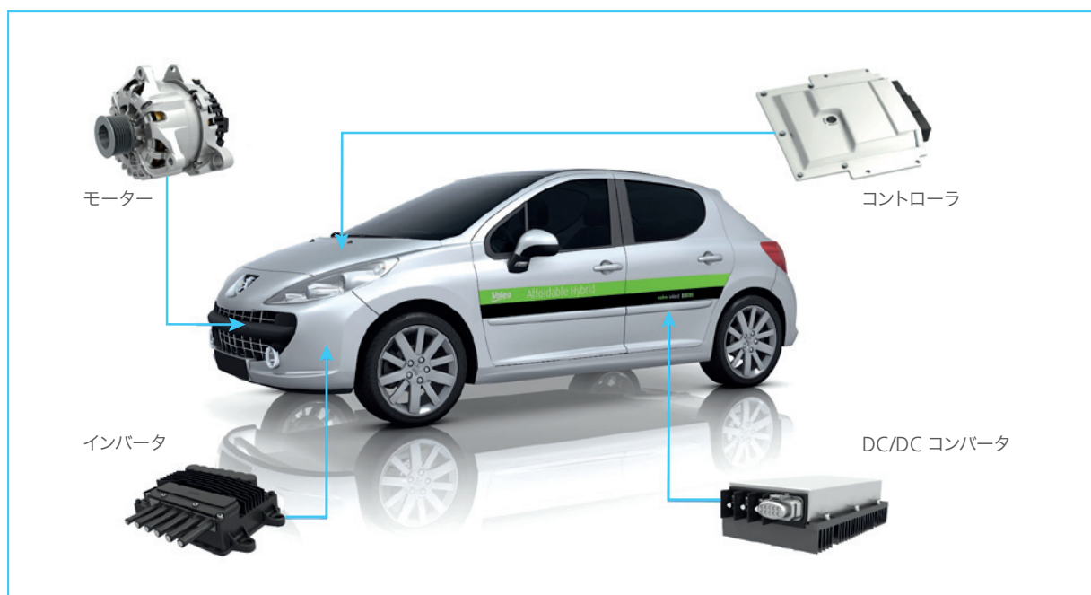
図2：VALEO 社のデモ用ハイブリッド車の構成
