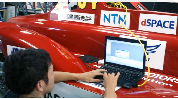
Abbildungen 1-4, von oben nach unten: Abstimmung der Regler auf der MicroAutoBox; Das Rennteam für das Pikes-Peak-Rennen; Die Fahrer Greg Tracy (links) und Hiroshi Masuoka (rechts) mit den Pokalen für die Plätze 2 und 3; Der MiEV Evolution II auf der Rennstrecke
