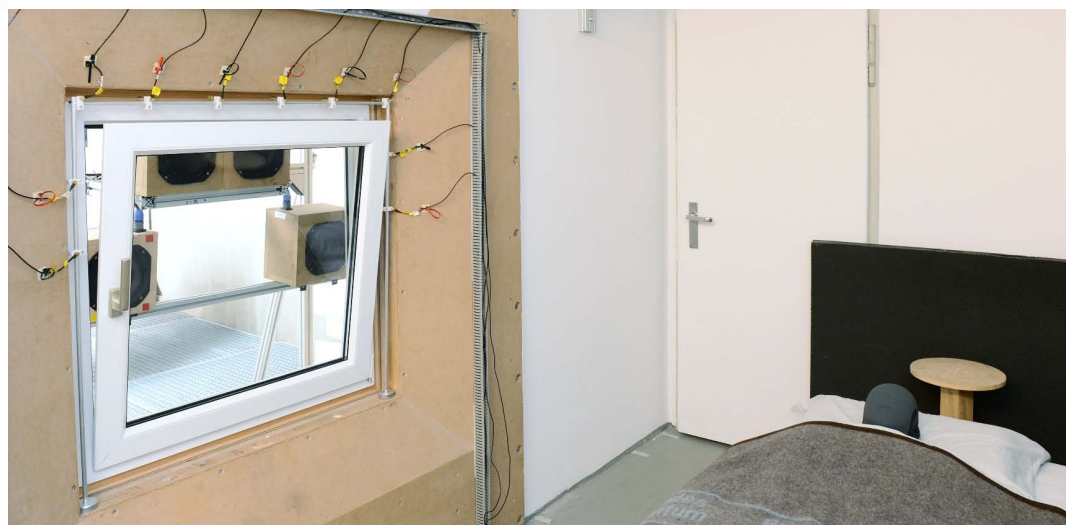
Abbildung 1: Die Gegenschalllautsprecher reduzieren den Lärm bereits vor dem Fenster (Dritte Projektphase).
