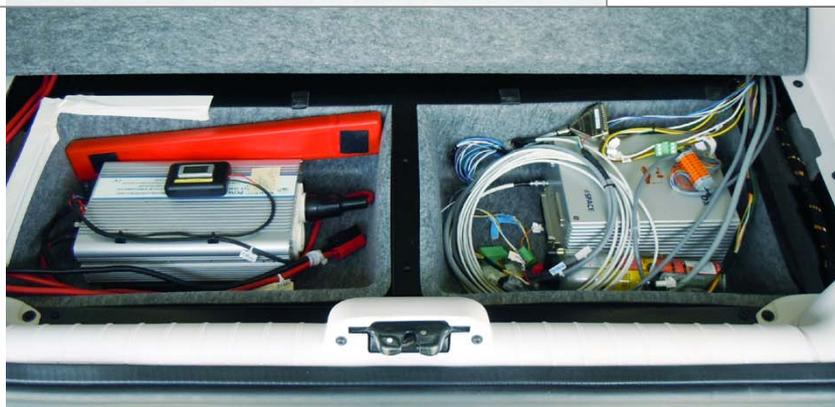
Im französischen Toulouse entwickelte Continental Automotive einen halb-automatischen X-by-Wire-Parkassistenten und integrierte ihn im Rahmen des europäischen POLLUX-Projekts in das Elektrotestfahrzeug „TH!NK“. Mit dem Rapid-Control-Prototyping-System MicroAutoBox gelang eine schnelle und zuverlässige Integration der innovativen Lenkung.
