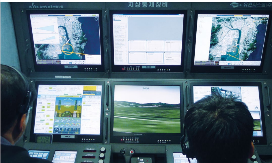
Abbildung 4: Die Überwachungsstation überträgt Befehle an das Flugzeug und zeigt sämtliche Instrumente des Flugzeugs. Virtuelle 3D-Grafiken erlauben einen virtuellen Blick ins Cockpit, der zum Überwachen der Flugzeugsituation hilfreich ist, falls die Pilotenkamera ausfallen sollte.
