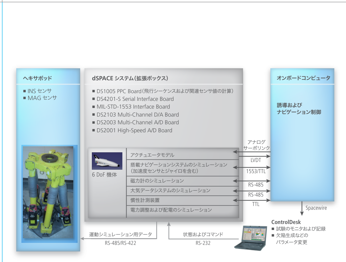
図4：dSPACE システムは飛行力学とセンサ/アクチュエータのモデルをリアルタイムで演算します。このデータを使用してオンボードコンピュータをテストします。これと並行して、実際のセンサを取り付けたヘキサポッドによって現行の飛行動作が実行されます。
