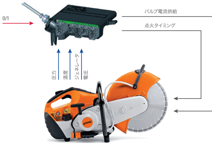
図1：点火タイミング制御にエンジン回転数だけでなく業界で初めて負荷情報も採り入れたSTIHL Injection
