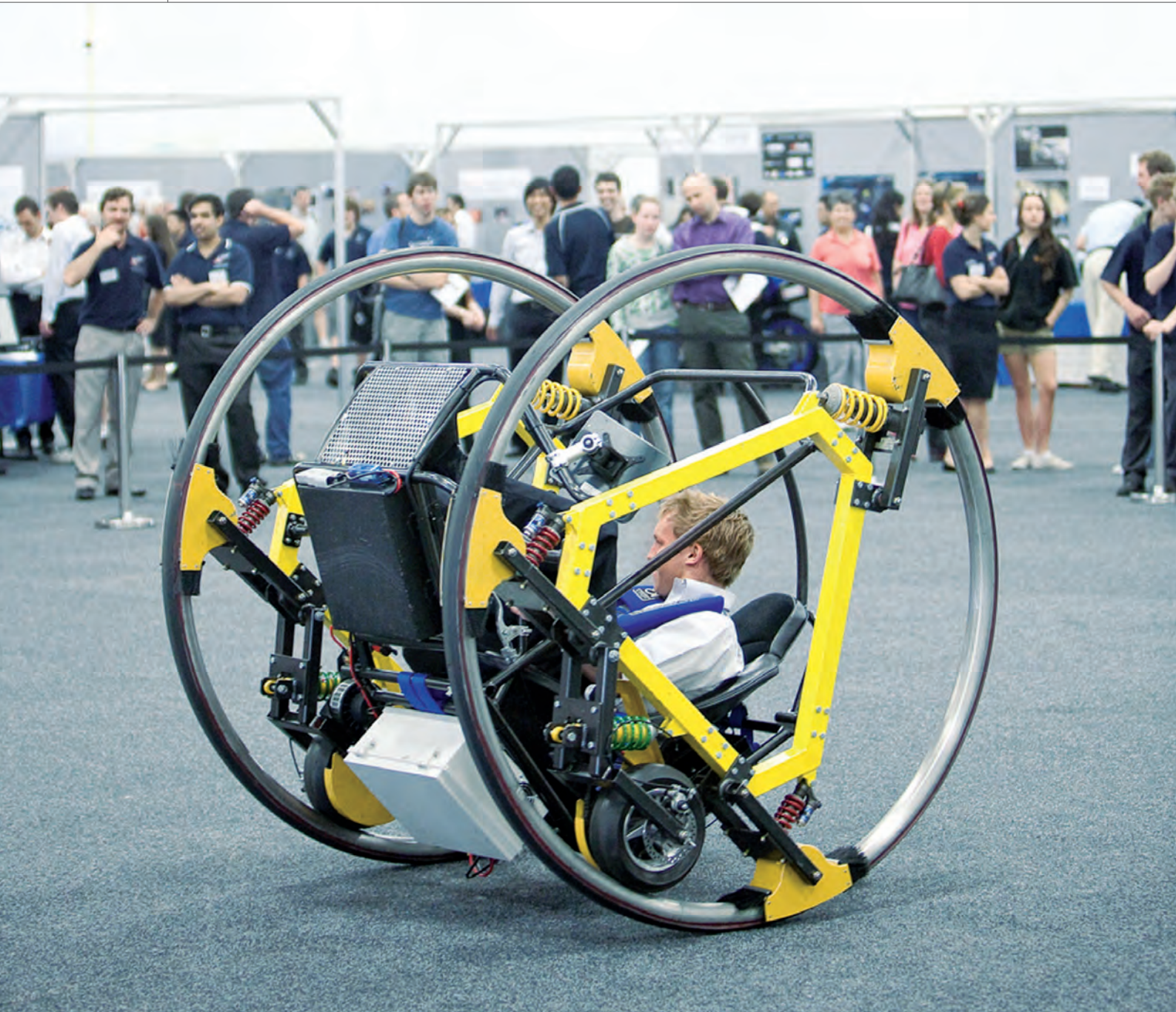
図 1 : アデレード大学で開発された EDWARD (Electric Diwheel With Active Rotation Damping : アクティブ回転抑制を備えた電動 Diwheel)
