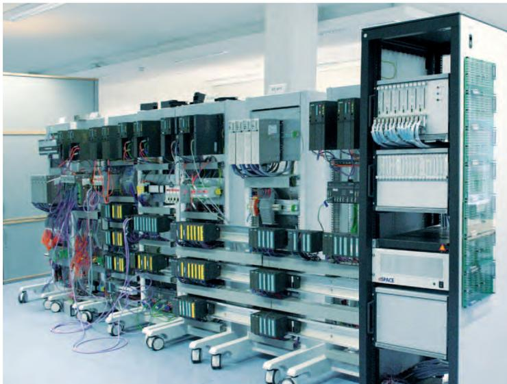
Abbildung 6: Aufbau des Prüffelds samt Simulator im Labor.
