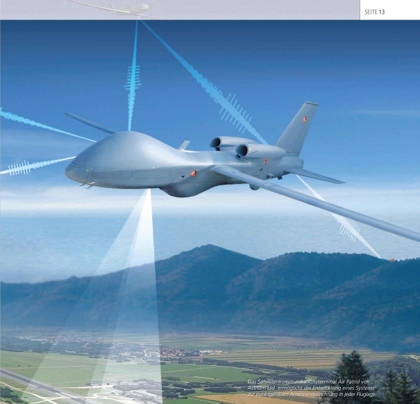
*Das Satellitenkommunikationsterminal Air Patrol von Astrium Ltd. ermöglicht die Entwicklung eines Systems zur punktgenauen Antennenausrichtung in jeder Fluglage.*
