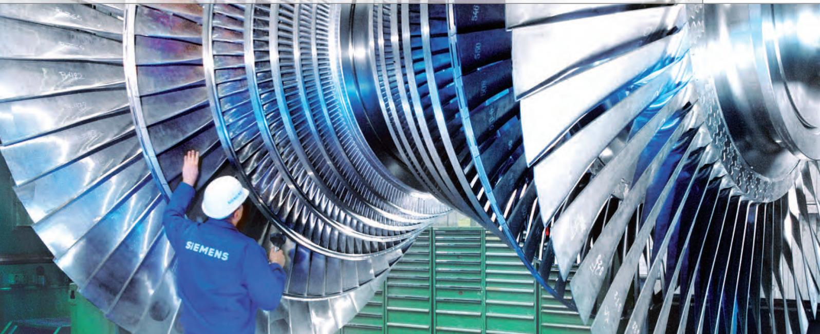
Abbildung 2: Rotor einer Dampfturbine.
