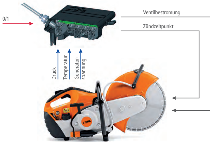
Abbildung 1: Mit STIHL Injection wird der Zündzeitpunkt erstmals nicht nur über die Drehzahl, sondern auch über die Last bestimmt.
