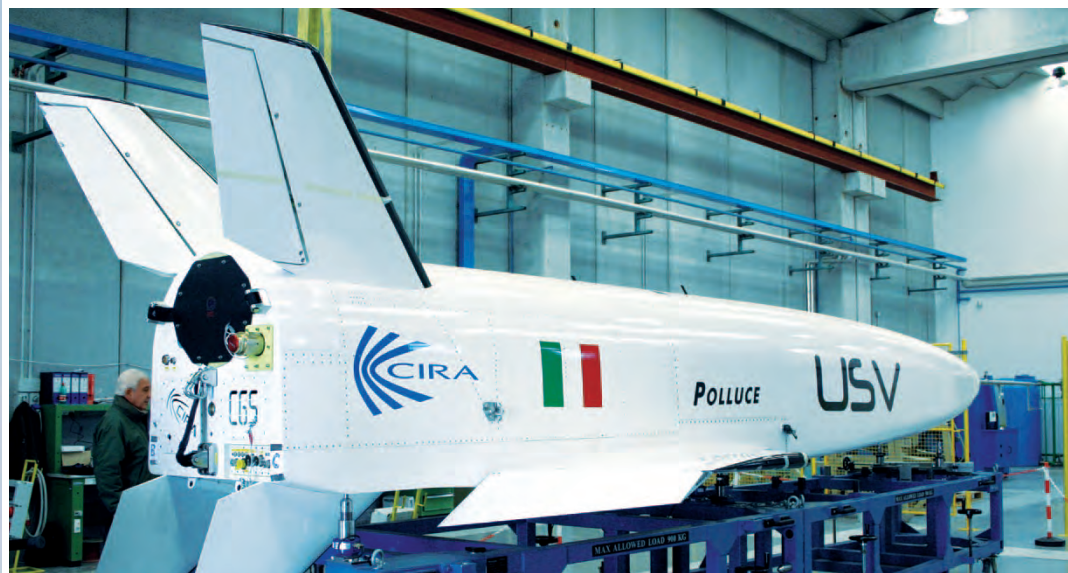
Abbildung 1: Das ca. 9 m lange USV gleitet antriebslos zur Erde zurück, gesteuert allein von einem Bordcomputer.
