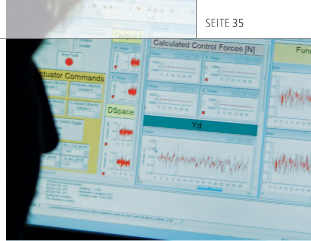
Abbildung 3: Ein typisches ControlDesk-Layout, das bei der Entwicklung der aktiven Federung zum Einsatz kam.
