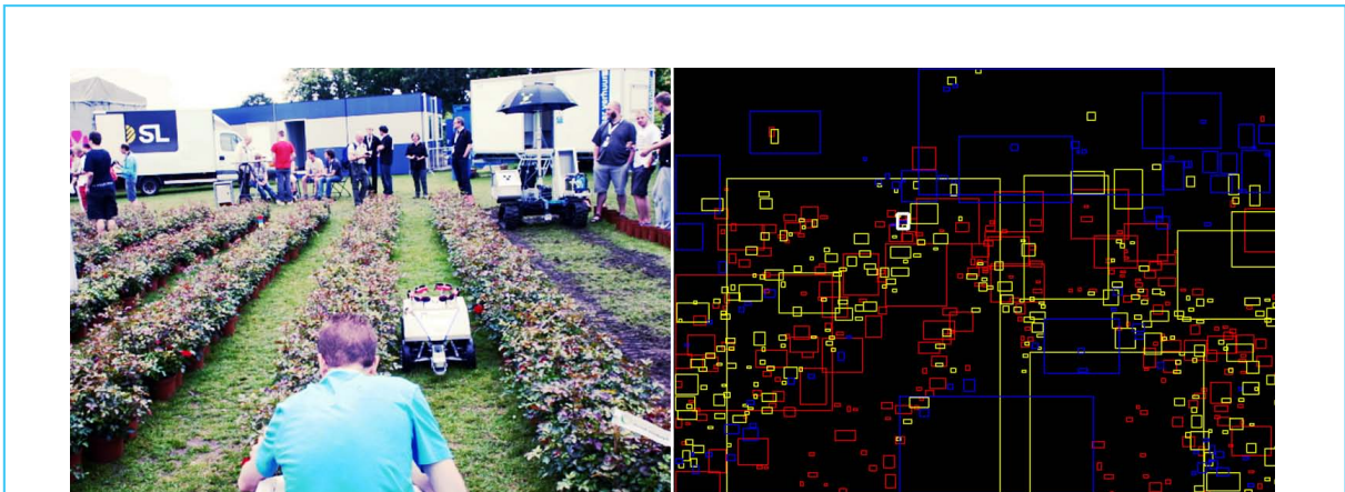
図4: OpenCVによる元の画像内のマーク付き鉢植えの物体認識 (左: 赤、青、黄の3色の縞模様の円筒)、認識された色の領域 (右: 赤、青、黄の枠)、および識別された鉢植えのマーク (右: 白い枠)。
