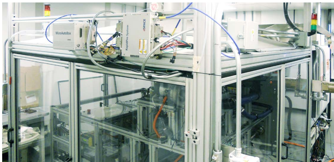
図3: MicroAutoBoxとRapidProによる燃料電池システムのラボセットアップ
