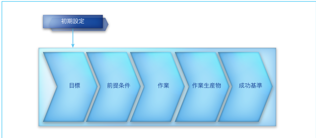
図5: Siemens社のドライブテクノロジー部門のISO 26262準拠開発プロセスの各フェーズの基本的なトピックとステップの構造
