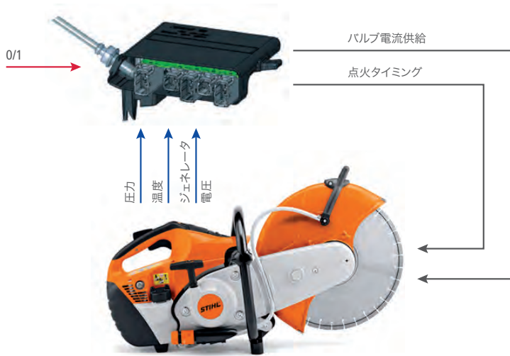
図1：点火タイミング制御にエンジン回転数だけでなく業界で初めて負荷情報も採り入れた STIHL Injection
