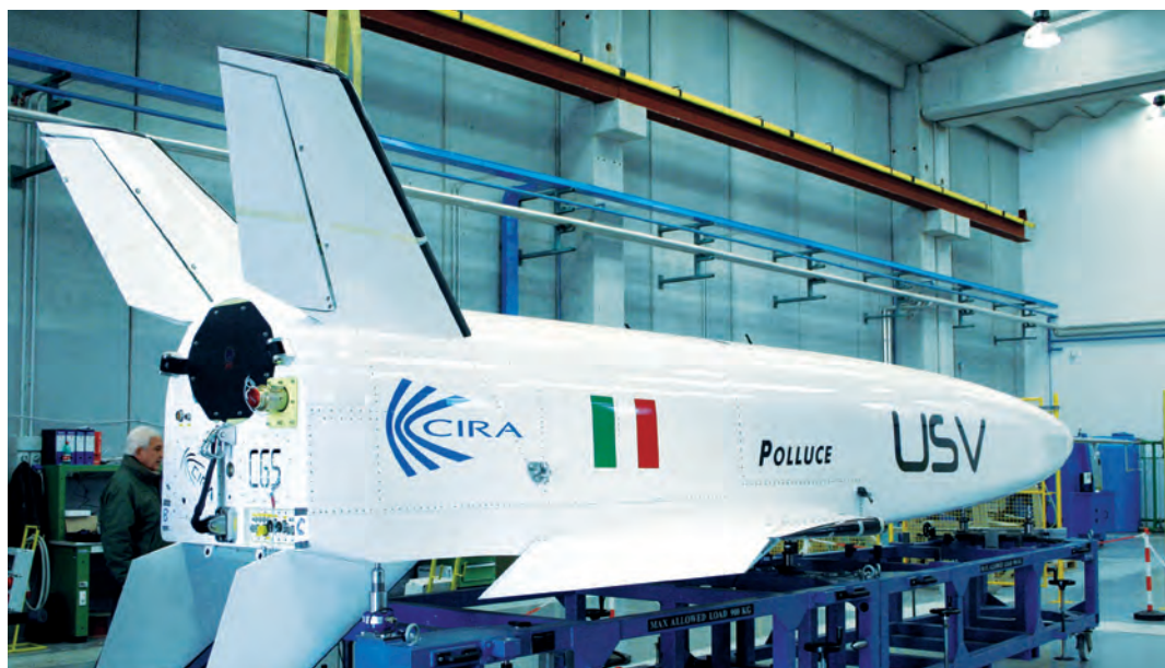
図 1：全長約 9 m の USV は、オンボードコンピュータのみで誘導され、無動力状態で滑空しながら地球に帰還します。
