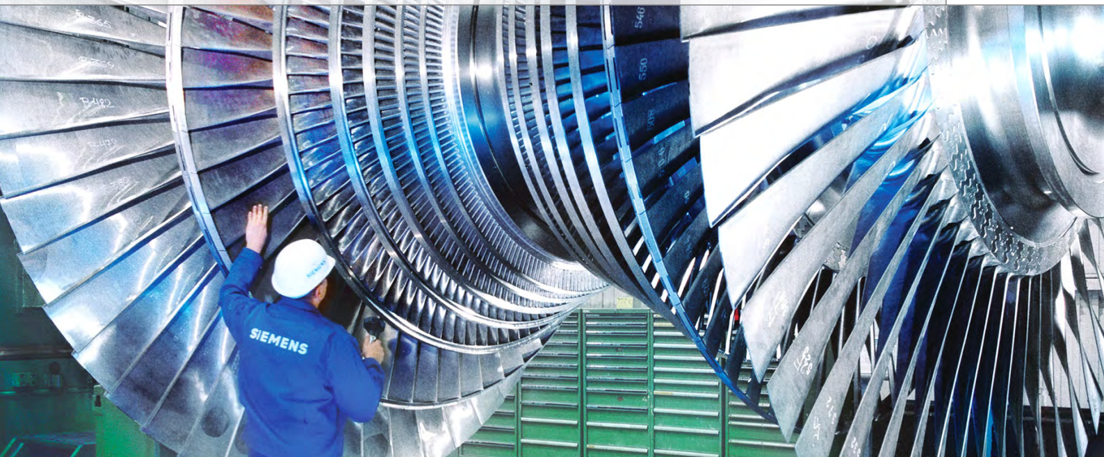
図2：蒸気タービンのローターブレード
