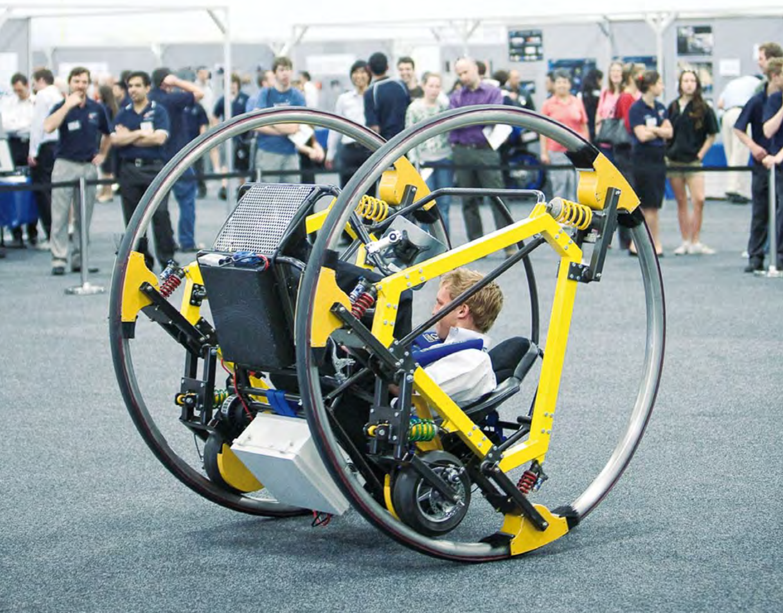
Abbildung 1: Das Gefährt namens EDWARD (Electric Diwheel With Active Rotation Damping), entwickelt an der Universität Adelaide.
