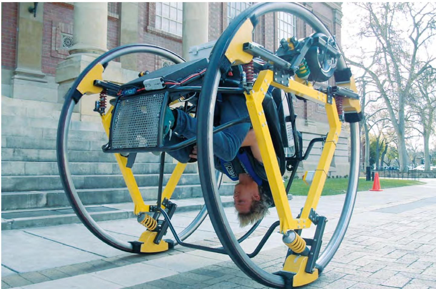
Abbildung 4: Durch den Regelmodus 'Überkopfregelung' kann der Student Jack Parsons kopfüber fahren.
