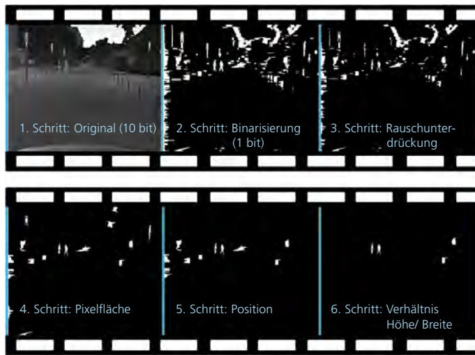
Die verschiedenen Schritte der Bildvorverarbeitung führen zur Detektion der potentiell auszu-leuchtenden Objekte.
