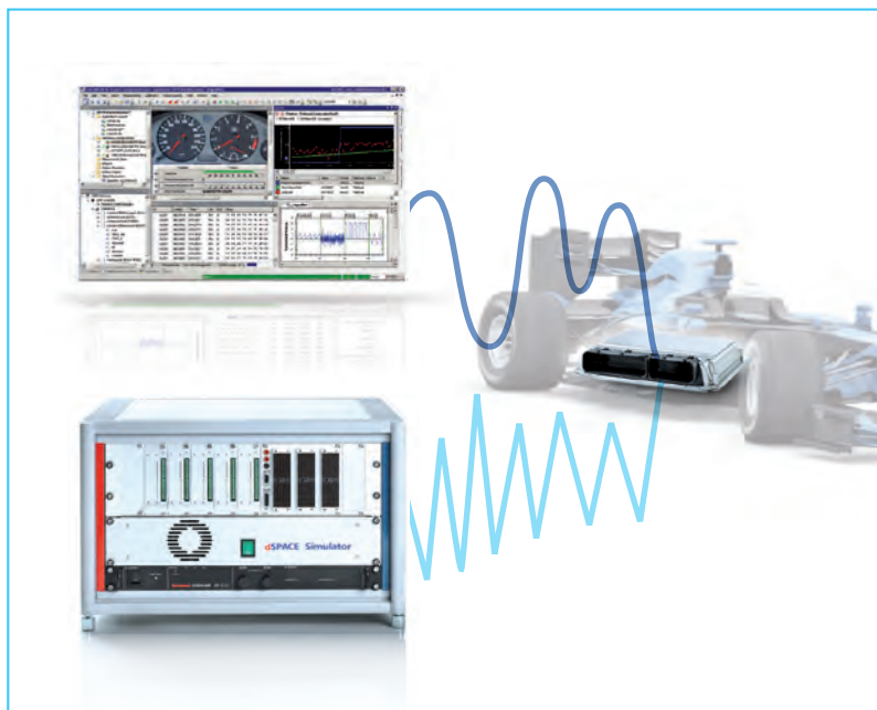
図 4：記録した信号は、F1 マシンの ECU を最適化するなどの目的で、テストベンチで行う HIL テストに使用できます。
