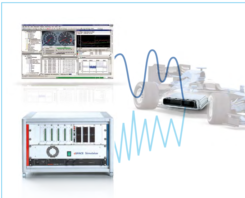
Abbildung 4: Aufgezeichnete Signale können für HIL-Tests am Prüfstand verwendet werden, z. B. für die Steuergeräte-Optimierung bei Formel-1-Fahrzeugen.
