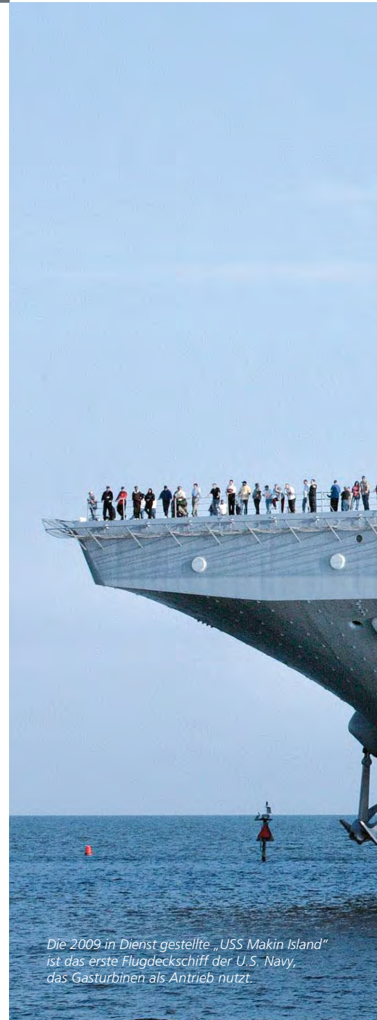
Abbildung 1: Flugdeckschiffe wie die Makin Island besitzen im Gegensatz zu klassischen Flugzeugträgern kein Startkatapult. Sie dienen als Basis für Hubschrauber, Senkrechtstarter und Landungsboote.
