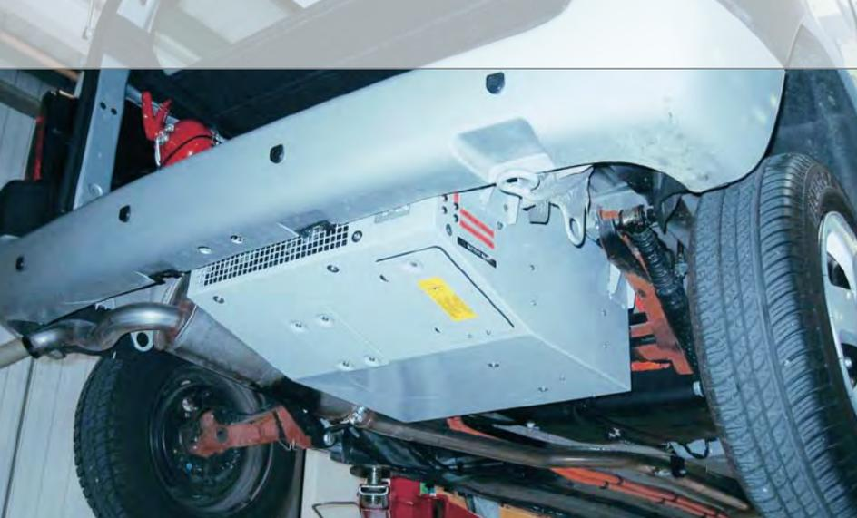
Integration eines Batteriepacks in ein Fahrzeug.
