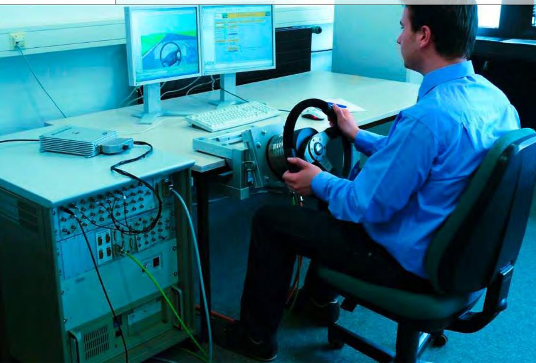
Abbildung 1: HIL-Prüfstand mit Feedback-Lenkrad.
