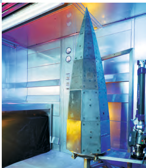
図 1 : 左 : ペイロードノーズコーンは 2 m を少し超える長さを持ち、平面耐熱パネルを備えています。 右 : パネルの取り付け作業。パネルの下に、温度センサ、圧力センサ、およびその他の機内計測用の装置が配置されています。
