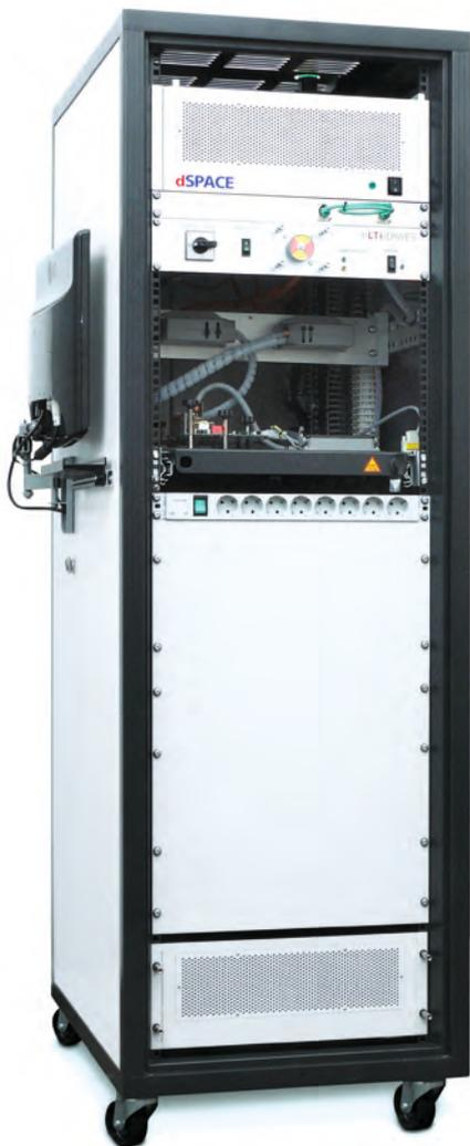
図 2 : HIL シミュレータの外観
