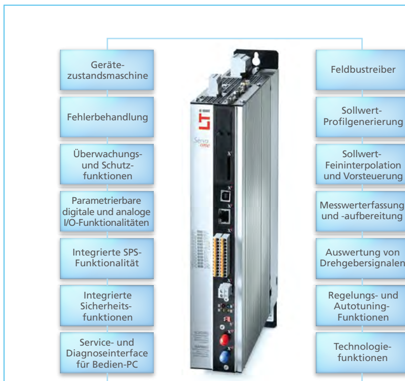
Abbildung 1: Typische Software-Funktionsbausteine eines Servoreglers.
