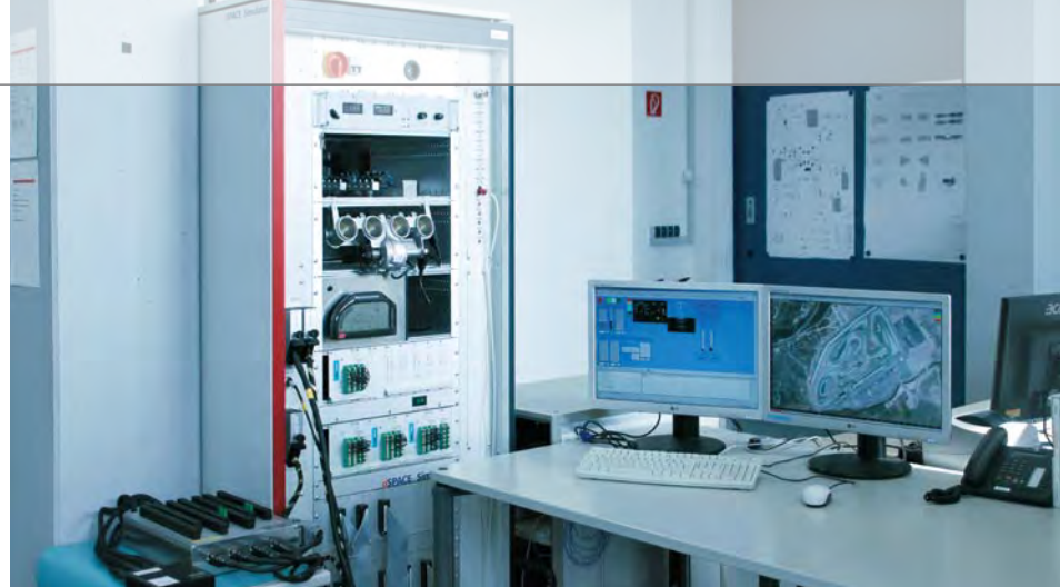
Labor-Test des Motorsteuergerätes RSM5 von BMW Motorrad Motorsport am dSPACE HIL-Prüfstand.
