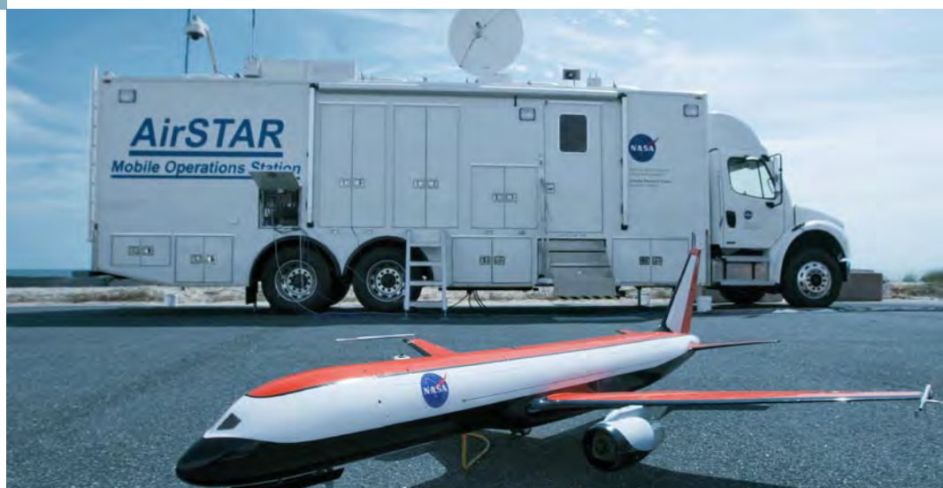
Abbildung 1: Die Testflüge mit dem UAV (hier vor der mobilen Bodenstation) dienen zur Optimierung der Funktionen für Flugsteuerungscomputer in Verkehrsflugzeugen.
