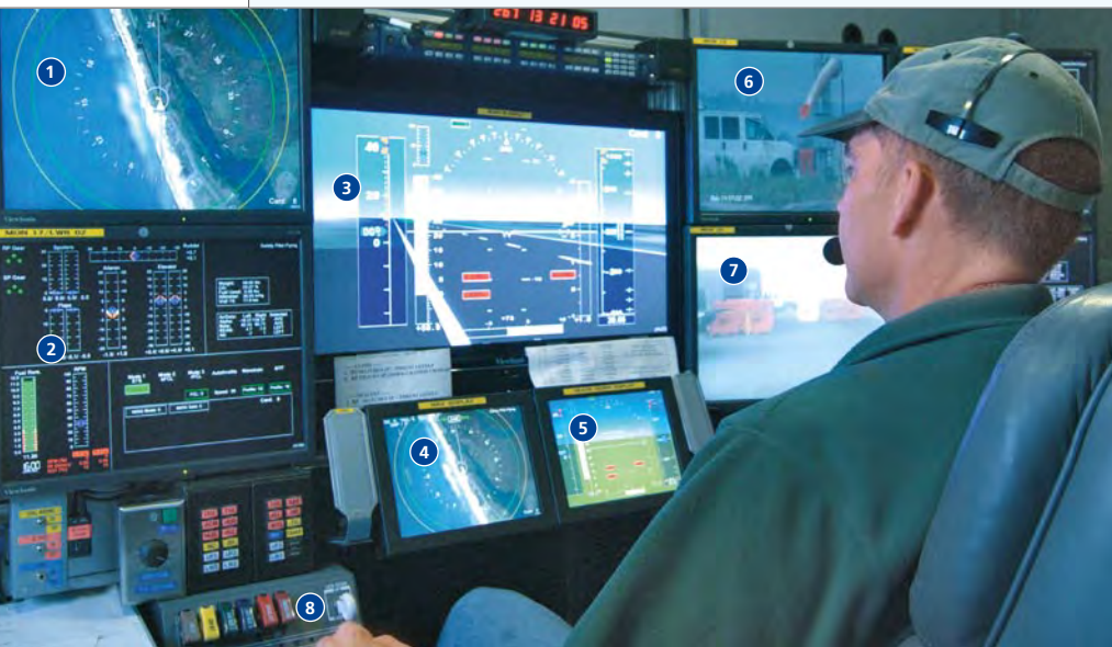
Abbildung 2: Der Platz des Testpiloten. Das per Funk mit dem UAV kommunizierende dSPACE-System erledigt alle anfallenden Echtzeit-Berechnungsaufgaben, damit der Testpilot vom Boden aus beliebige Manöver realitätsnah fliegen kann.
