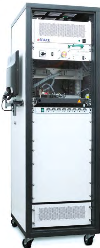
Abbildung 2: Der Schaltschrankaufbau des HIL-Simulators.
