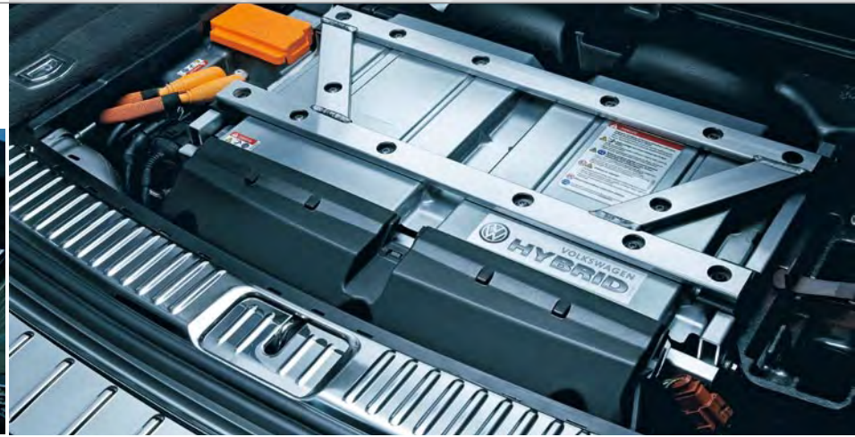
Die NiMH-Batterie ist im Heck verbaut.
