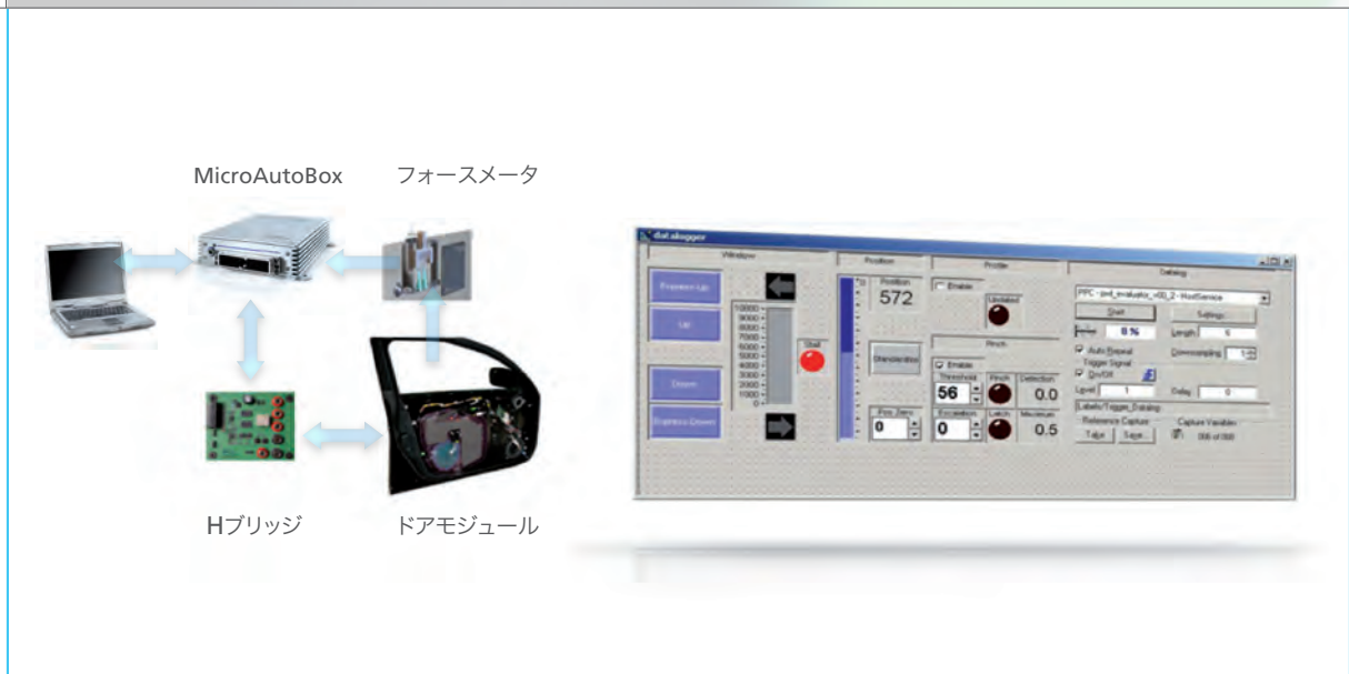
図 2 : 左 : MicroAutoBox を使用したアルゴリズム検証用テストベンチ 右 : ControlDesk エクスペリメントレイアウト
