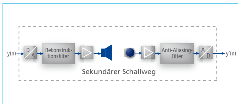
Abbildung 3: Übertragungsfunktion zwischen Reglerausgang und Fehlersignaleingang.
