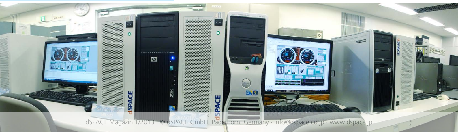
図6: リアルタイムMILシミュレーションを実行するワークステーション
