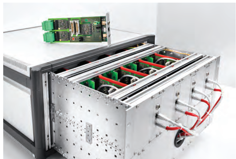
Abbildung 2: Der modulare Aufbau des dSPACE Batteriemanagementsystems erlaubt maßgeschneiderte Ausbaustufen bis ca. 200 Zellen und lässt sich auch direkt im Fahrzeug einbauen.
