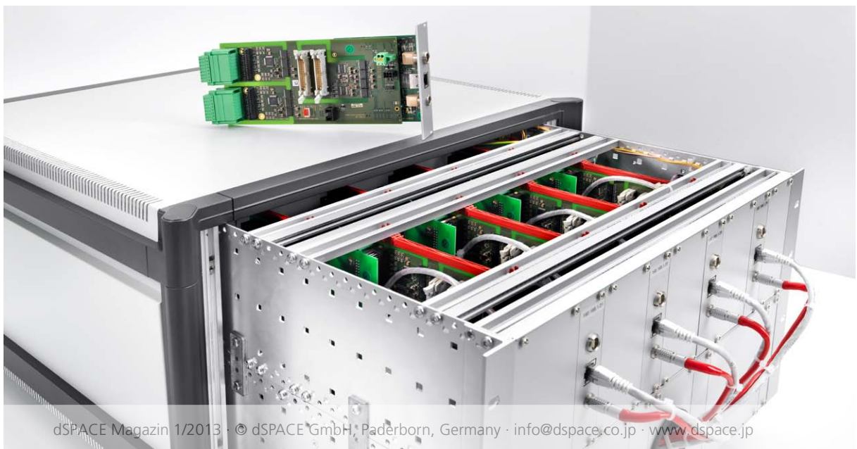
図2: モジュラー構造を持つdSPACEバッテリーマネジメントシステム - 最大で約200セルまで柔軟に構成でき、車両に直接搭載することも可能
