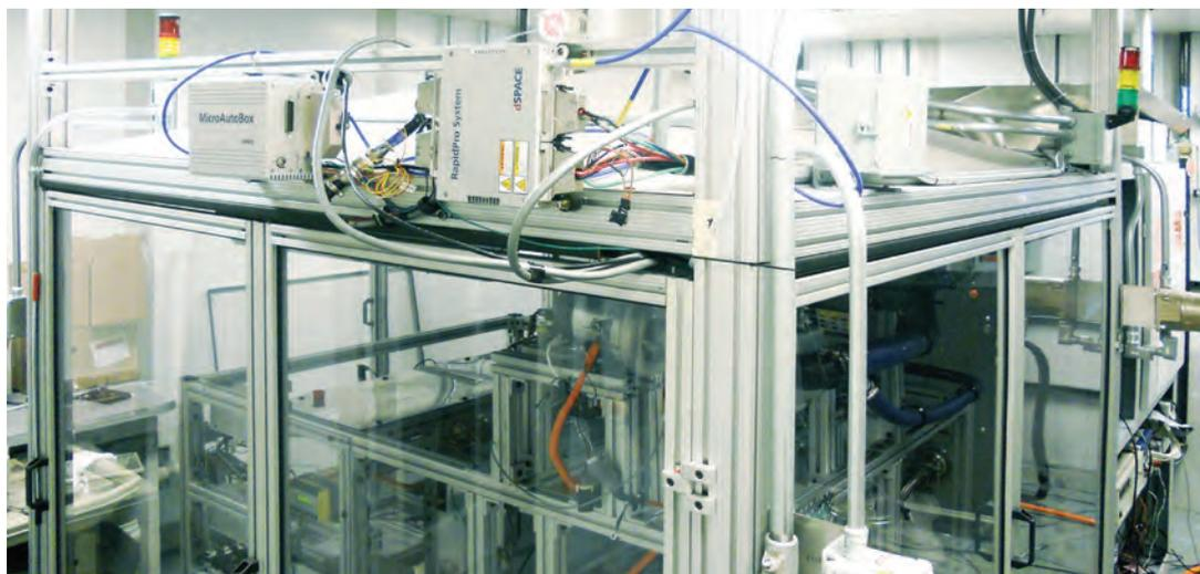
Abbildung 3: Laboraufbau des Brennstoffzellensystems mit MicroAutoBox und RapidPro.
