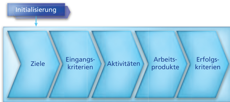
Abbildung 5: Struktur fundamentaler Themen und Prozessschritte für jede Prozessphase des ISO-26262-konformen Entwicklungsprozesses bei Siemens Drive Technologies.
