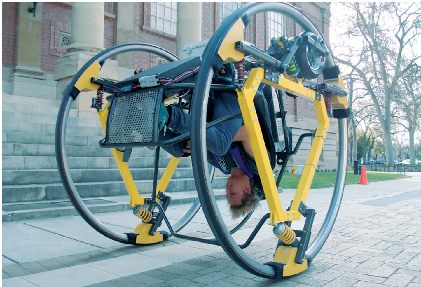
図 4 : フィードバック制御により上下逆さまの状態での運転中の Jack Parsons (学生)
