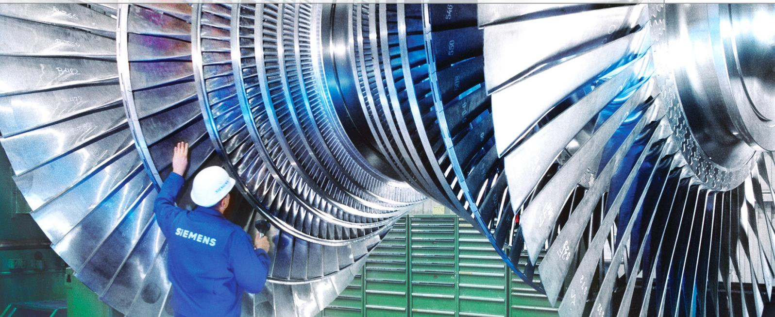
図2：蒸気タービンのローターブレード
