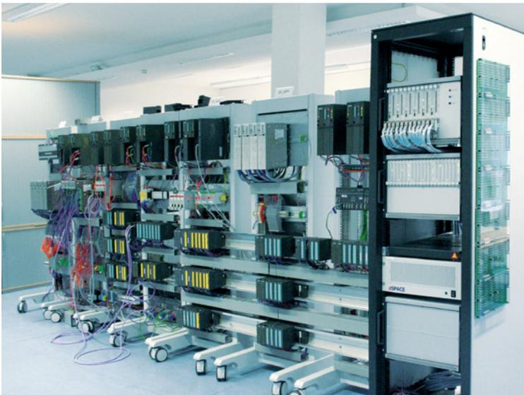
図 6 : 試験施設内に設置された、シミュレータを含むテストラポアセンブリ
