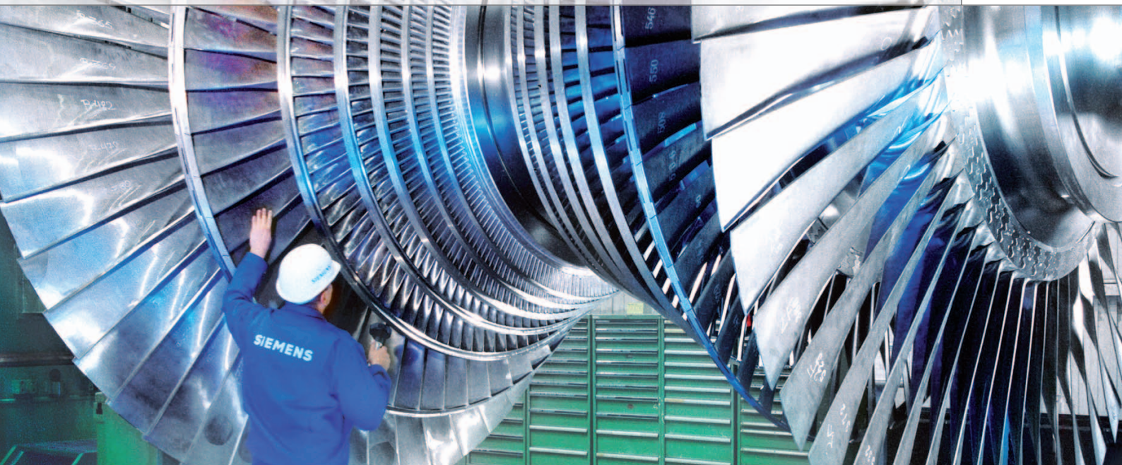
Abbildung 2: Rotor einer Dampfturbine.
