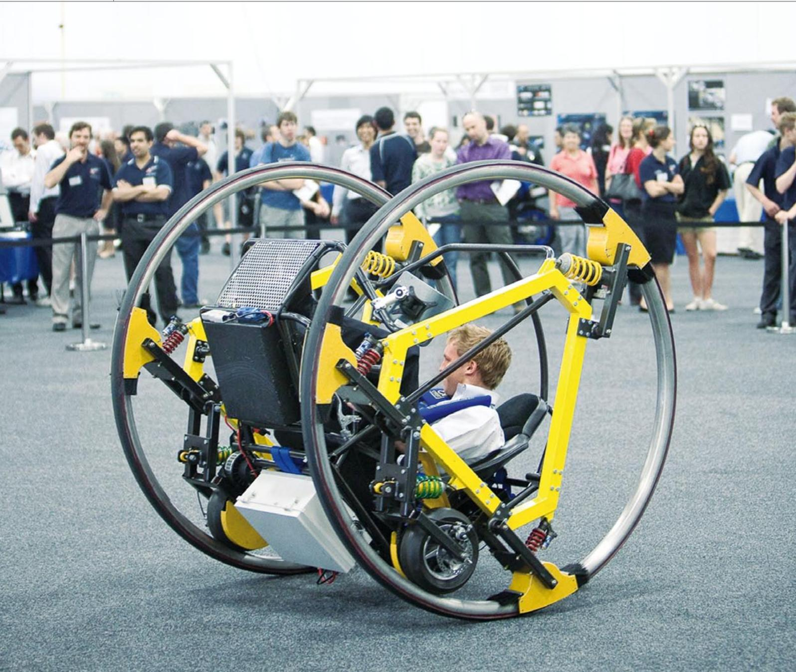
Abbildung 1: Das Gefährt namens EDWARD (Electric Diwheel With Active Rotation Damping), entwickelt an der Universität Adelaide.
