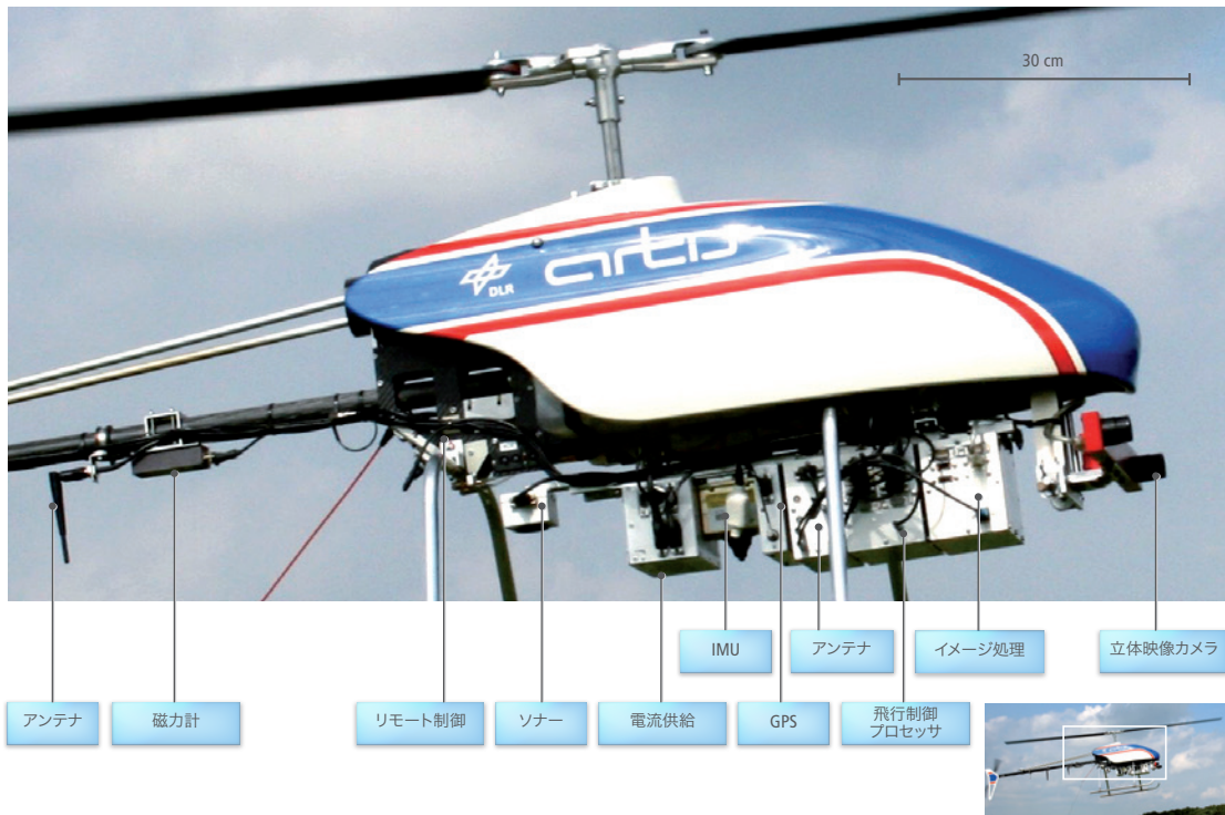
DLRの研究用UAV(ここで紹介するARTISなど)には、多くのオンボードシステムが搭載されています。これらは、飛行の安定化、飛行軌道の事前設定、自動離着陸などに使用されます。
