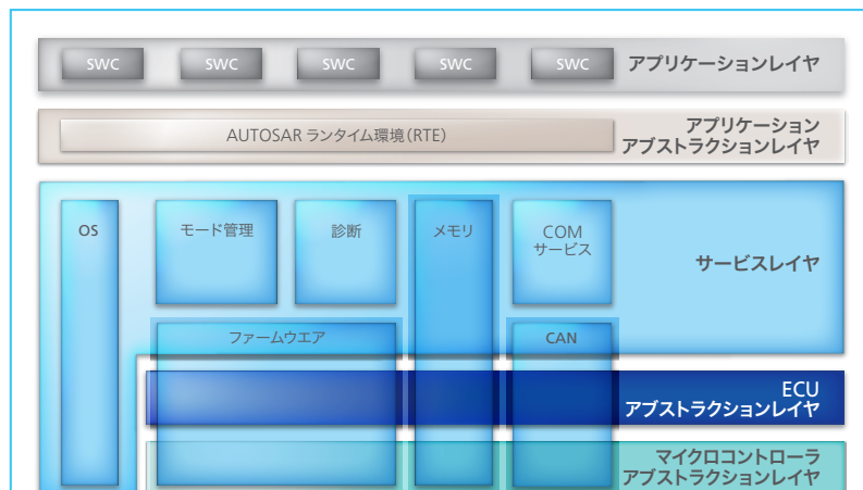
図 2 : AUTOSAR ソフトウェアアーキテクチャの階層構造
